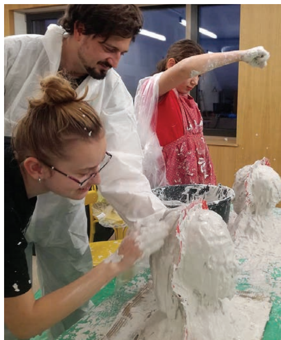
Pak se vytvoří sádrová tzv. ztracená forma, která se vylije sádra
